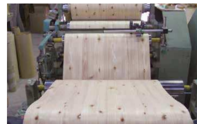
不燃シートの完成
